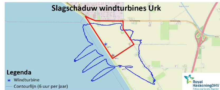
Figuur 15-3 Slagschaduwcontour (blauw, 6 uur per jaar) en plangebied (rood) (Bron: Royal Haskoning DHV 2019)
