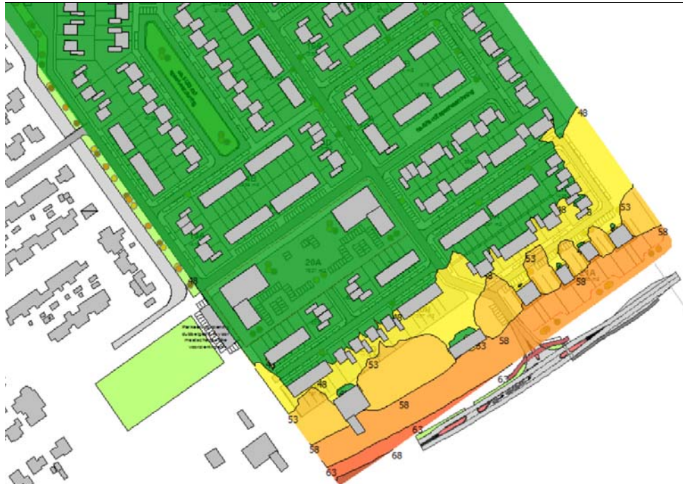
Figuur 5.2 Geluidscontouren N351 inclusief aftrek 2 dB artikel 110g op beoordelingshoogte van 4,5 meter
