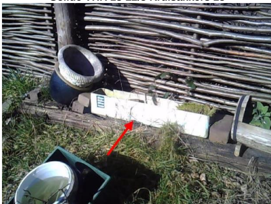
Foto 21. Asbesthoudende bloembak Kruisakkers 18
