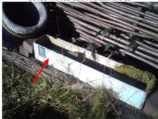
Foto 22. Asbesthoudende bloembak Kruisakkers 18
