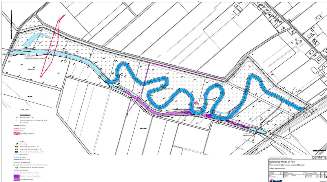
Afbeelding 4: Ontwerp verbreding meanders en dempingen
