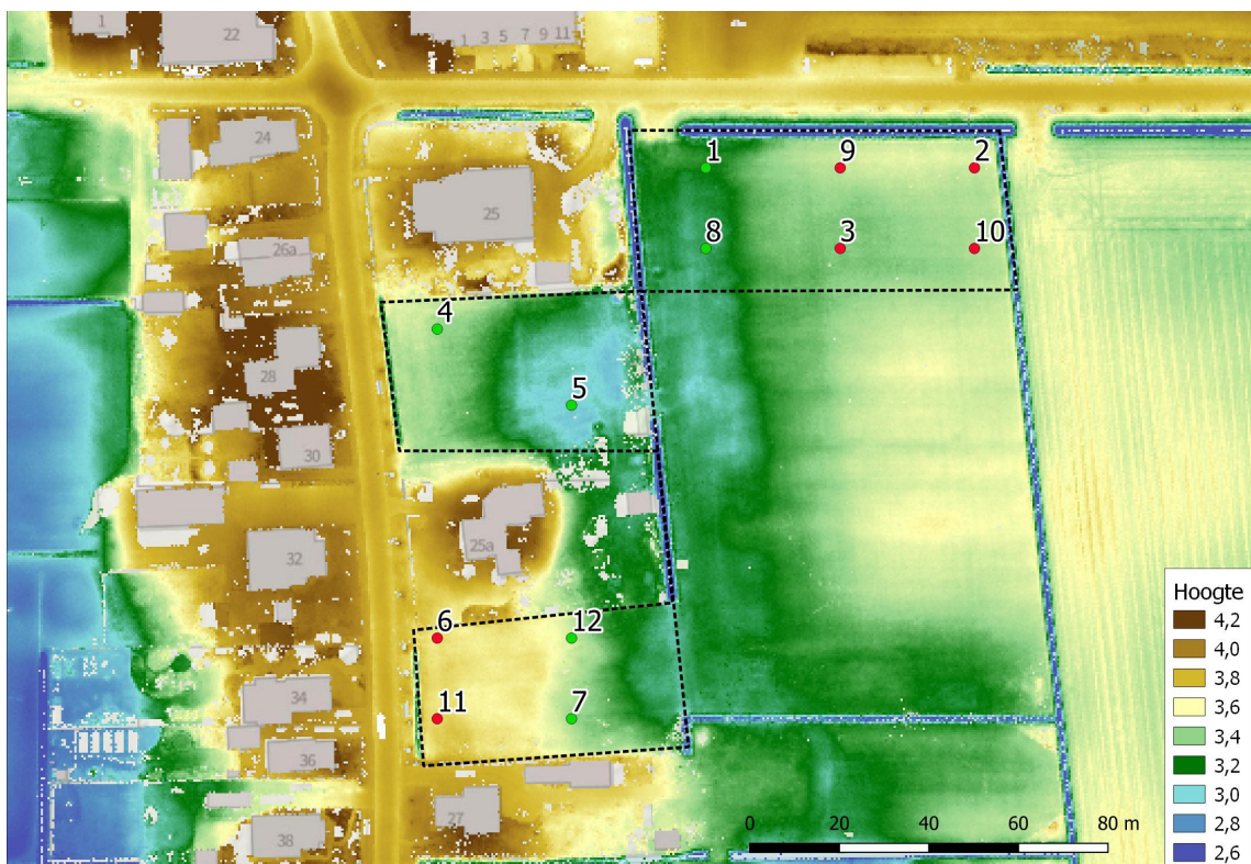
Figuur 8: Gieterveen, Boerendijk: boorpuntenkaart. De twaalf genummerde punten zijn boorlocaties. Bij rood gekleurde is een restant van een podzolbodem vastgesteld, bij groen gekleurde is de bodem verstoord tot in het gele zand. Het plangebied wordt weergegeven door de gestreepte zwarte lijn. Als achtergrond is een hoogtekaart gebruikt, gemaakt met het Actueel Hoogtebestand Nederland 3 uit 2019.
