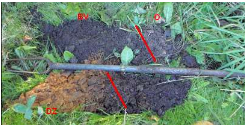
Afbeelding 15. Foto van boring 4 waarbij O: opgebracht, BV: bouwvoor, DZ: dekzand
