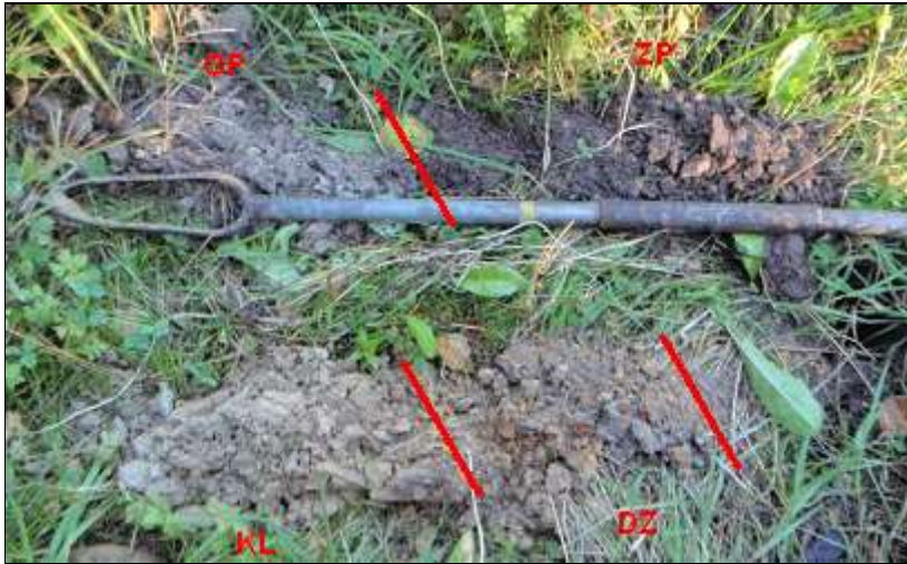
Afbeelding 14. Foto van boring 1 waarbij ZP: bouwvoor met puin, GP: opgebrachte laag met puin, DZ: dekzand met roestvlekken, KL: keileem
