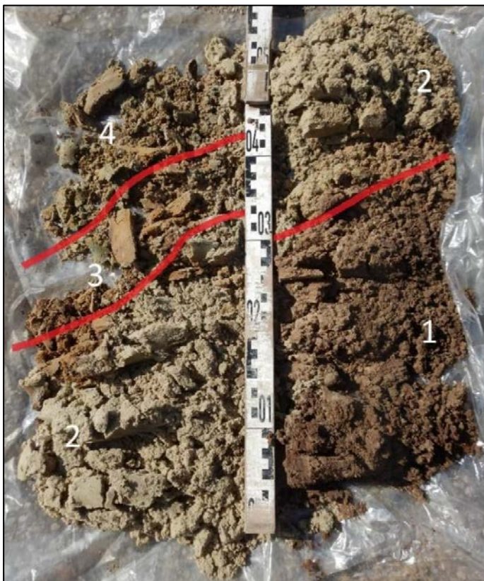
Afbeelding 15. Boring 9 met interpretatie (leesrichting van beneden naar boven, eerst rechts van de meetlat, dan links van de meetlat): 1 en 2 = opgebracht zand, 3 = C-horizont, 4 = keileem
