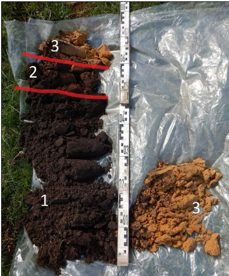
Afbeelding 16. Boring 13 met interpretatie (leesrichting van beneden naar boven, eerst links van de meetlat, dan rechts van de meetlat): 1 = bouwvoor, 2 = BC-horizont, 3 = C-horizont
