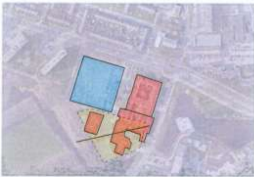
Fase 1: nieuwbouw Schoolgebouw op bouwlocatie sportveld, aansluitend/gelijktijdig slopen zuidelijk deel van het gebouw
