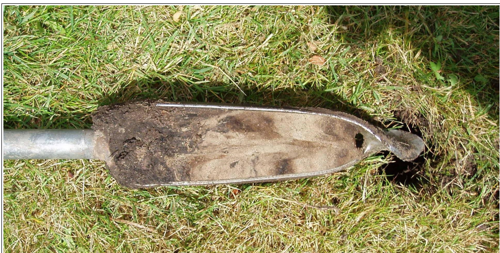
Figuur 7: Assen, Groen van Prinstererlaan 98: monster boring 7 van 100 tot 105 centimeter. In het zand zitten humeuze en lemige niveaus. Deze zijn gevormd tijdens iets warmere fases van de laatste ijstijd in een beekdal.
