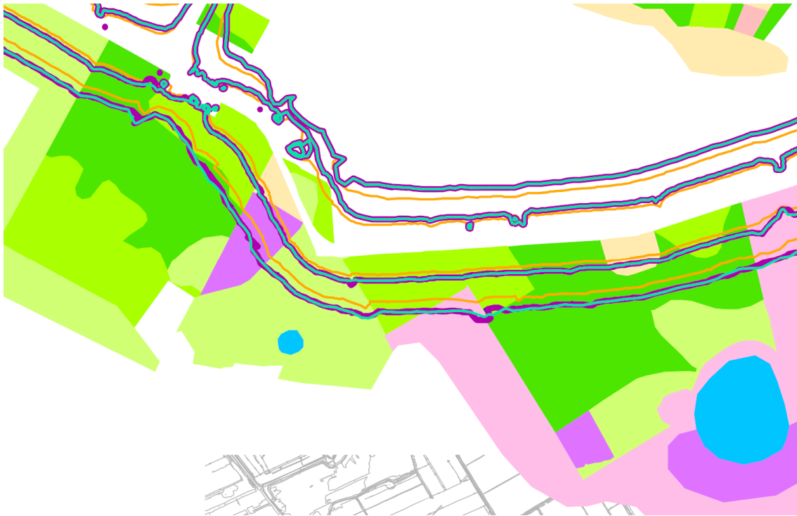
Figuur 6.4 Berekende geluidscontouren langs de N919. De bruine contourlijn geeft de huidige situatie weer, in blauw de situatie als gevolg van de autonome ontwikkeling en in lila de contourlijn 42 dB(A) en 47 dB(A) (Goudappel Coffeng 2010). De 47dB(A) lijn valt nagenoeg samen met die van de autonome ontwikkeling. De driehoekige oppervlakte heide in de bocht (rose, links van het midden in de figuur) is leefgebied van enkele broedparen roodborsttapuit.
