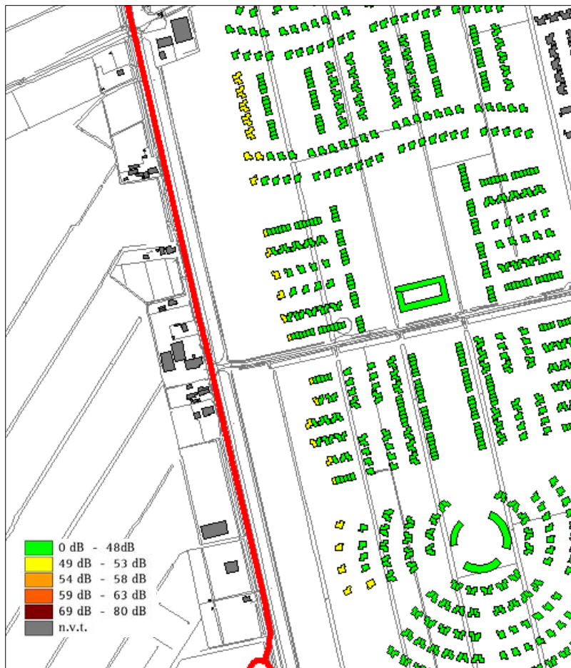
Figuur 5.4: Overzicht van woningen waarvoor sprake is van een overschrijding ten gevolge van de N371, na toepassing van geluidsreducerend asfalt (maatgevende waarneemhoogte 2 e verdieping)
