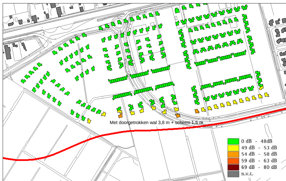
Figuur 5.3: Geluidssituatie na toepassing van geluidsreducerend asfalt en wal 3,8 + scherm 1,5 m (maatgevende waarnemhoogte 2 e verdieping)
