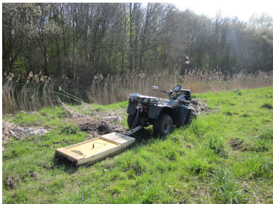
Figuur 2: quad met grondradar op de onderzoekslocatie.
