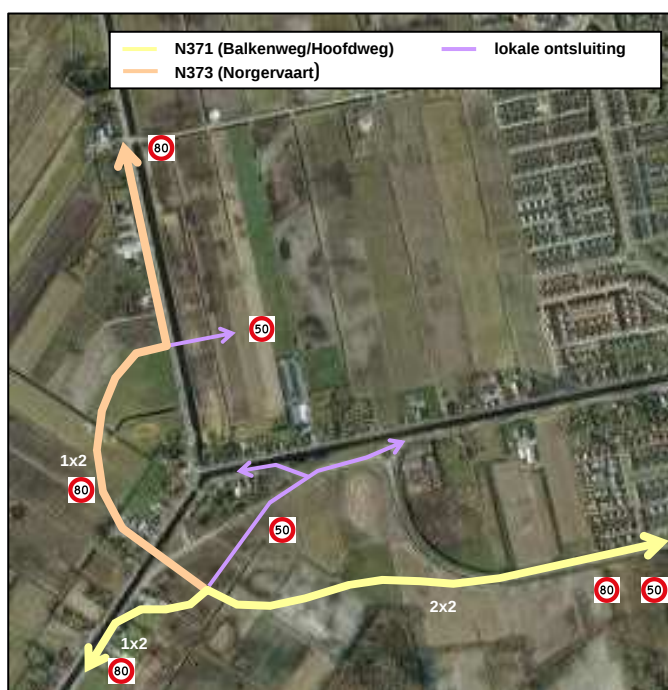
Figuur 1.2: Verkeersstructuur na realisatie van het voorgenomen plan
