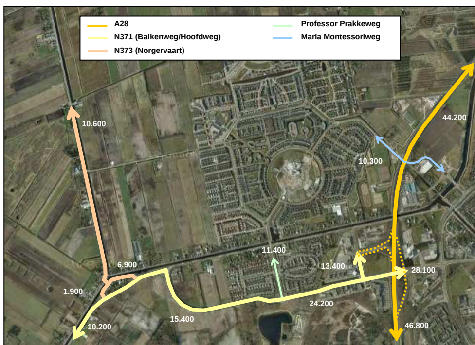
Figuur 3.2: Belangrijkste verkeersstromen op een weekdag (mvt/etm) in 2030 zonder planontwikkeling, de autonome situatie (bron: verkeersmodel)
