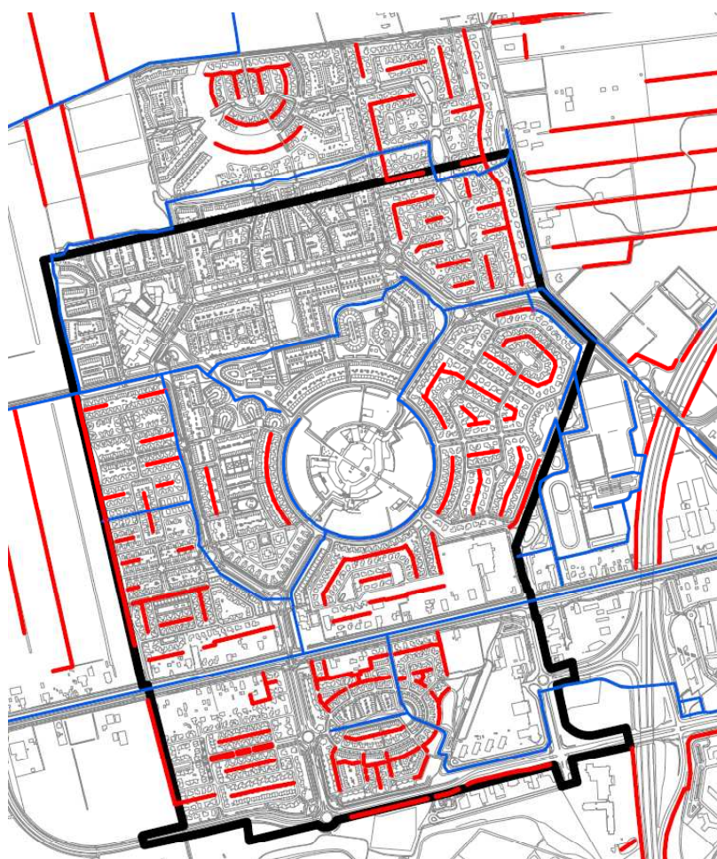
Figuur 32. overzicht schouwsloten en watergangen plangebied
