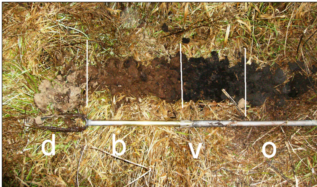
Afbeelding 10. Beeld van boring 1, d: dekzand, b: B-horizont, v: veen, o: opgebrachte grond
