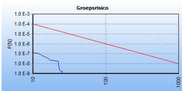
Figuur 8 FN-curve van de kilometer met de hoogste overschrijdingsfactor van gastransportleiding N-521-42 in de toekomstige situatie. De ligging van deze kilometer is hiernaast in het rood weergegeven op een topografische kaart.
