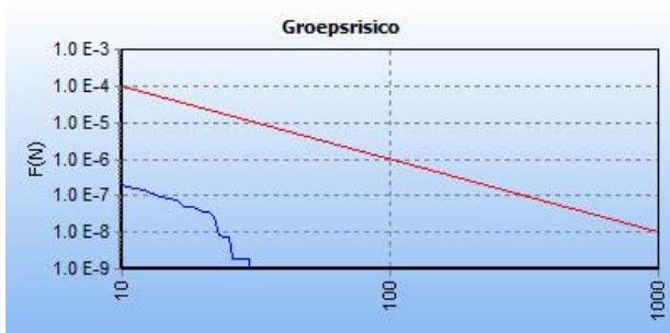
Figuur 6 FN-curve van de kilometer met de hoogste overschrijdingsfactor van gastransportleiding N-521-42 in de huidige situatie. De ligging van deze kilometer is hiernaast in het rood weergegeven op een topografische kaart.
