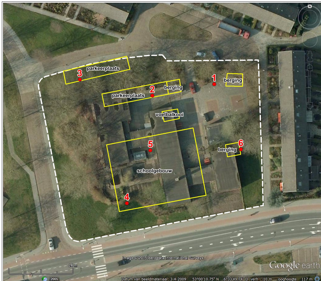
Figuur 7: Assen, Treubstraat 2: boorpuntenkaart. De genummerde zes punten zijn de locaties van de boringen. Met geel is de geplande inrichting van het nieuw te bouwen schoolterrein weergegeven.
