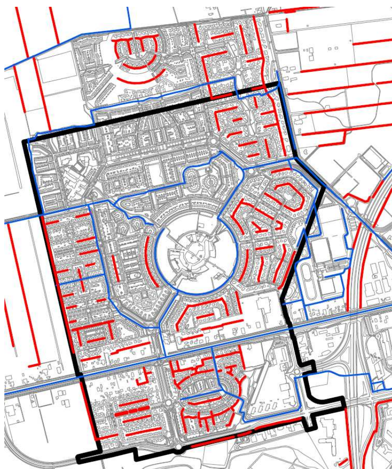
Figuur 32. overzicht schouwsloten en watergangen plangebied
