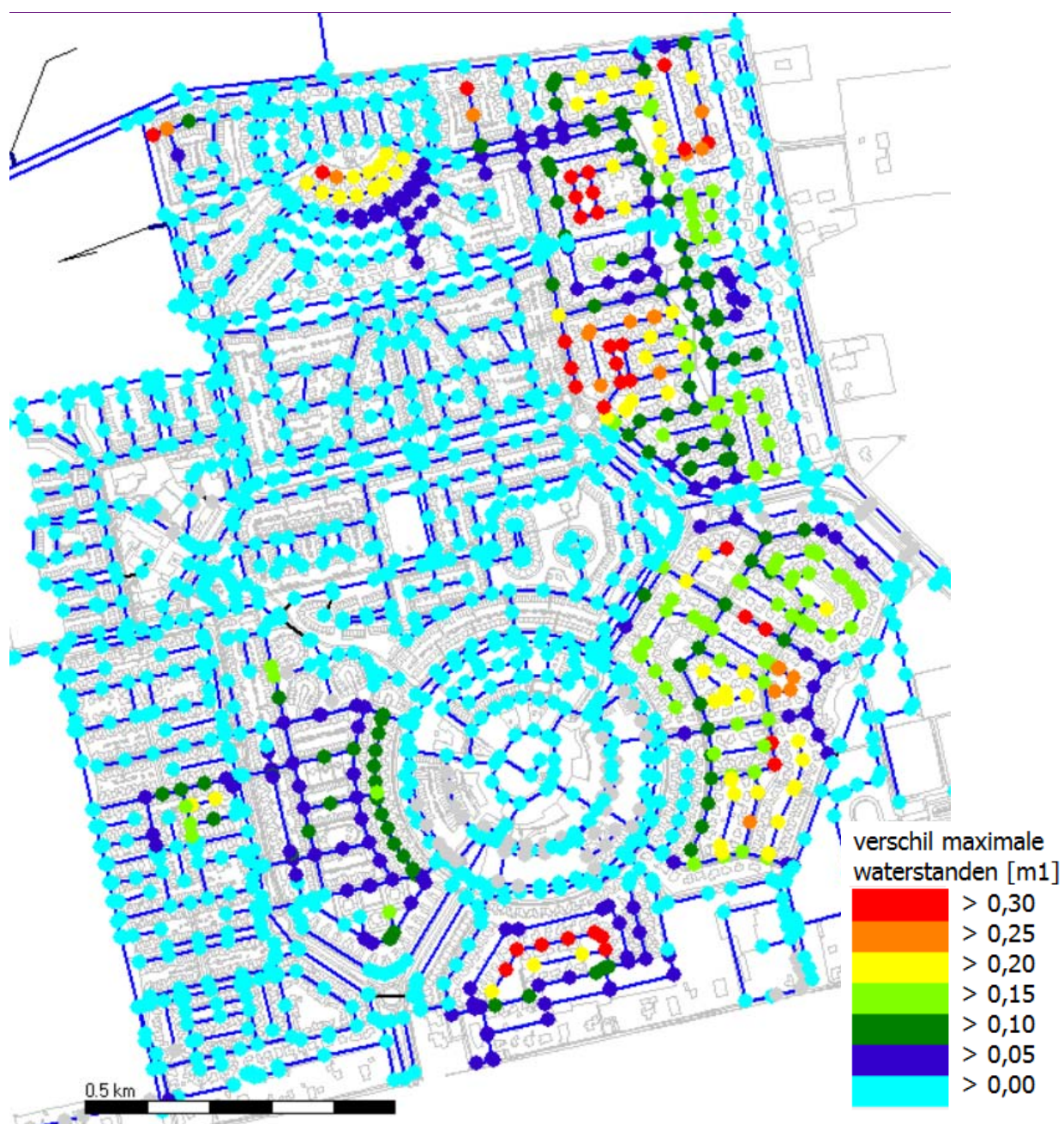
Figuur 6.5 Verskil maximale waterstanden profiel 810 en verbrede bak
