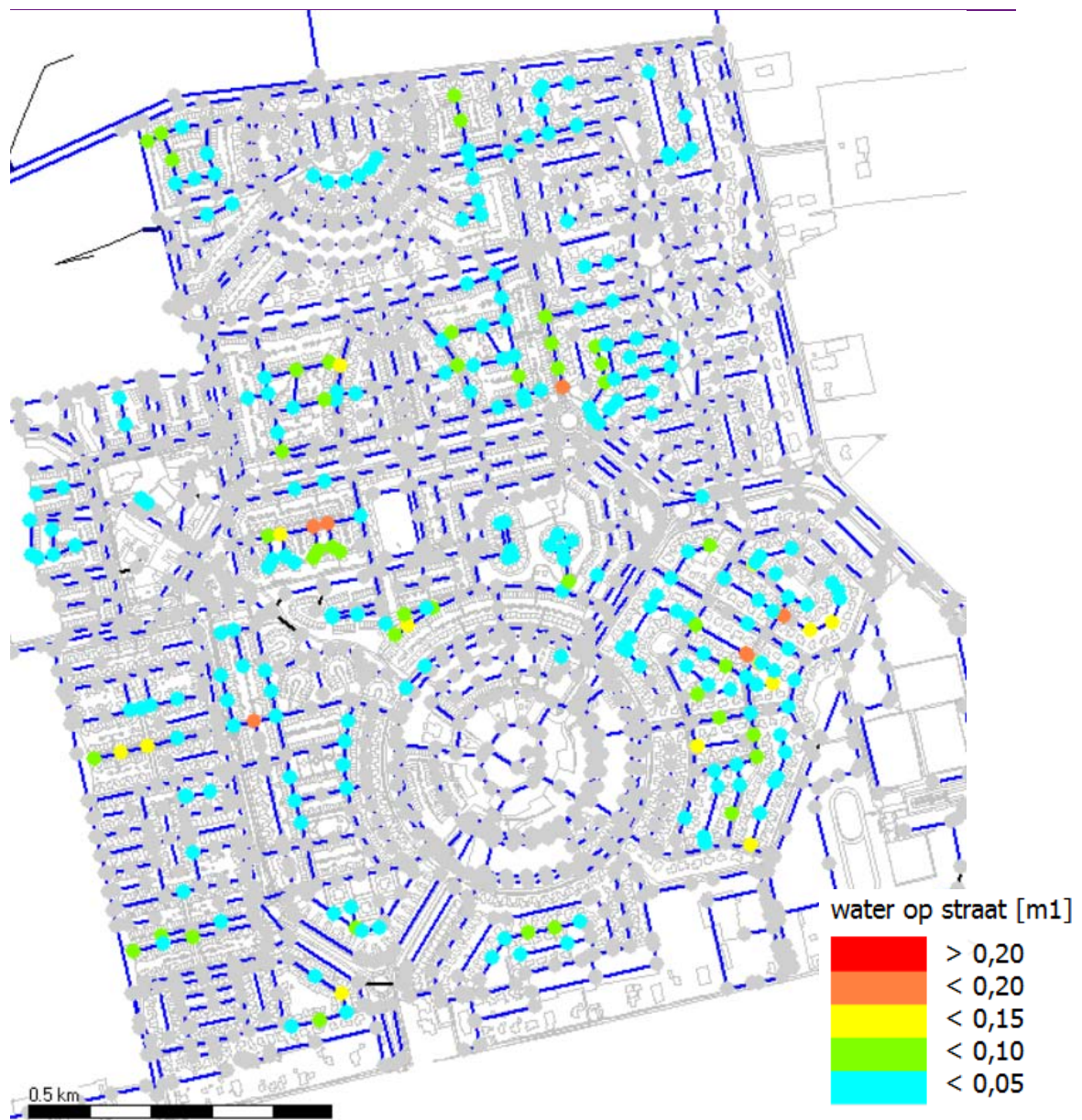
Figuur 5.3 Water-op-sstraat bij verbreed bakprofiel T=10 +13 %
