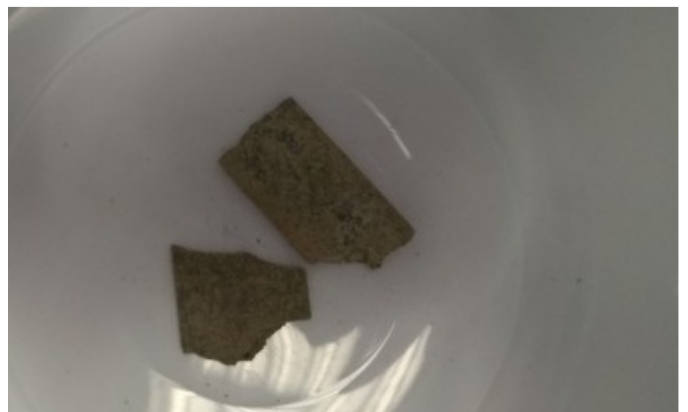
Foto 8: asbestverdacht materiaal GT4
