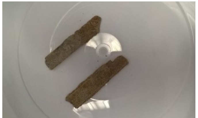
Foto 6: asbestverdacht materiaal GT3
