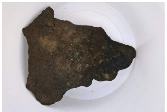
Foto 6: asbestverdacht materiaal SL21
