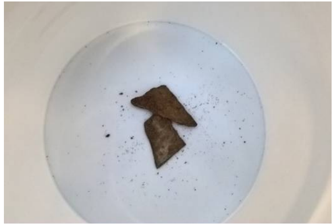
Foto 8: asbestverdacht materiaal SL22
