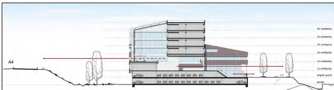
Figuur 1.2 Inpassing bouwlagen in maaiveld
