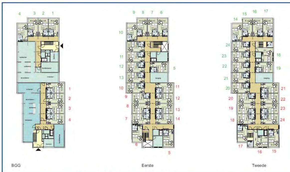
Afbeelding 3. Conceptindeling van het appartementencomplex
