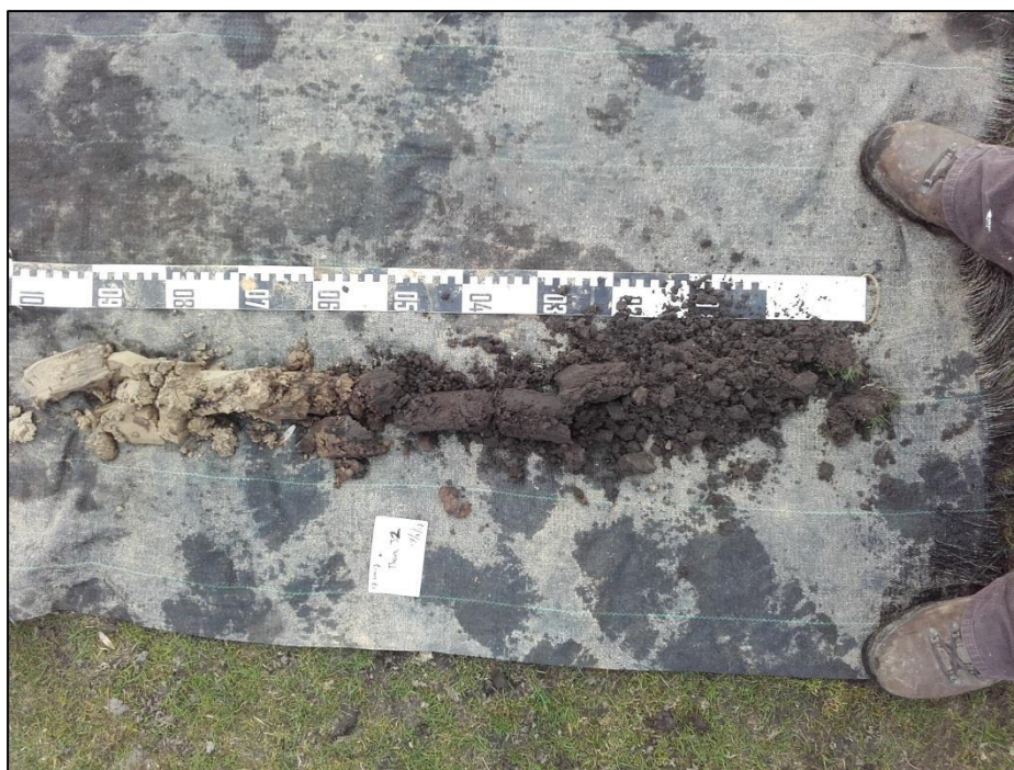
Figuur 3.6 Zicht op de bodemopbouw ter plekke van boring 32. Tot 30 cm –mv wordt de bodem gekenmerkt door een humeuze bouwvoor met een enkele fragment bouwpuin. Vanaf 30 cm –mv komt een humeuze, consistentere laag voor, welke als beekafzetting is geïnterpreteerd. Tussen 50 en 65 cm –mv komt een geelbruine horizont voor, die de top vormt van het door beekafzettingen afgedekte dekzand. Vanaf 65 cm is de lichtgrijze C-horizont zichtbaar.
