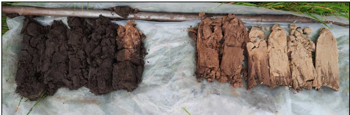
Figuur 6. Boorprofiel boring 3 (0 - 110 cm -mv). Leesrichting van links naar rechts.
