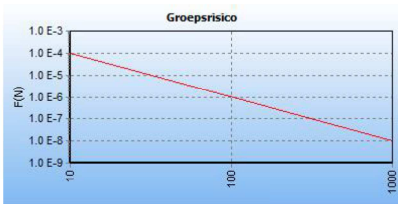
Afbeelding 6 fN-curve buisleiding A-525-01-deel-1, huidige situatie
