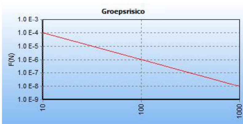
Afbeelding 8 fN-curve buisleiding A-525-01-deel-1, toekomstige situatie
