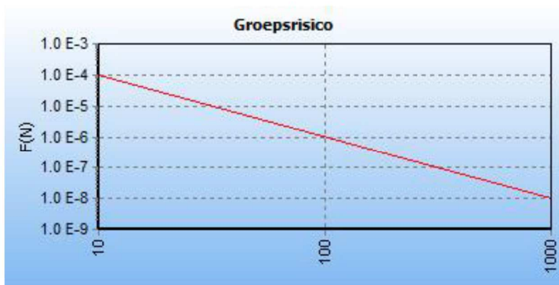
Afbeelding 13 fN-curve buisleiding A-525-05-deel-1, toekomstige situatie
