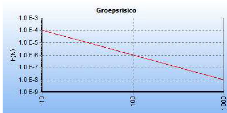
5.2 Figuur 5.2 FN curve voor 7688_leiding-A-525-05-deel-1 van N.V. Nederlandse Gasunie voor de kilometer tussen stationing 0.00 en stationing 1000.00
