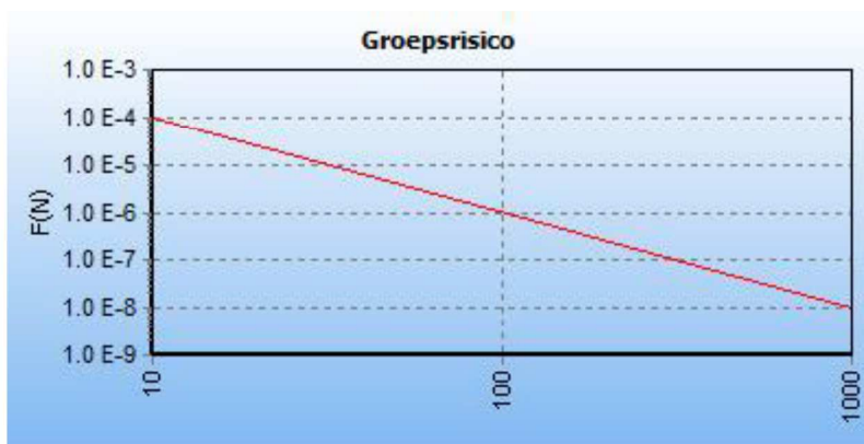
Afbeelding 11 fN-curve buisleiding A-525-05-deel-1, huidige situatie
