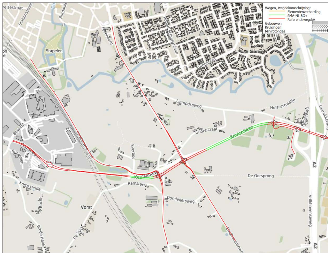
Figuur 5.2 Bronmaatregelvariant 1, combinatiedeklaag op kruis- en opstelvlakken, SMA-NL 8G+ over een lengte van 565 meter in cluster K1 en 200 meter in cluster K2
