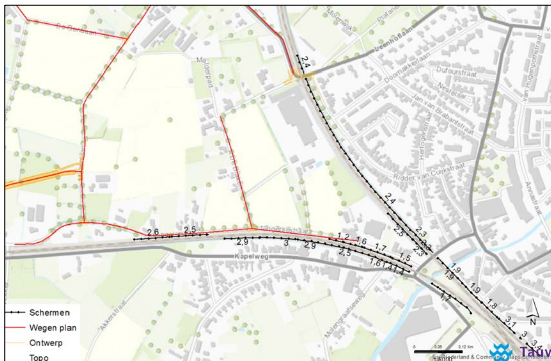
Figuur 3.9 Locatie en hoogte geluidsschermen (hoogte in meters ten opzichte van maaiveld bij de schermen)
