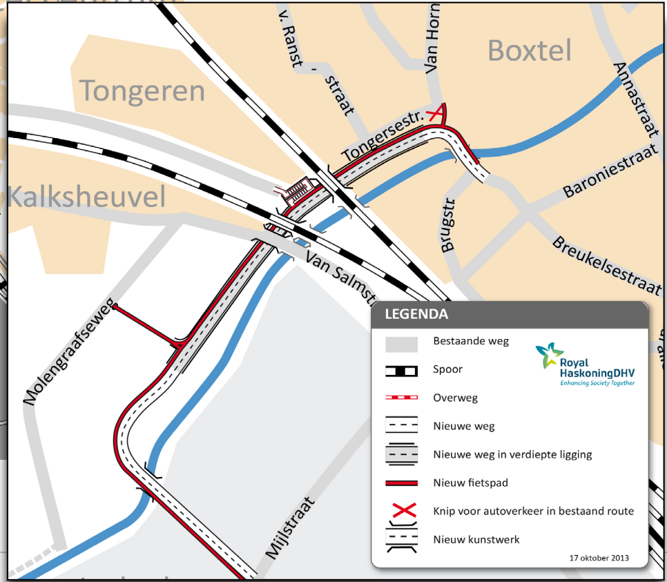
Detailontwerp tunnel variant 2: Tunnel Ladonk-Centrum Tongersestraat
