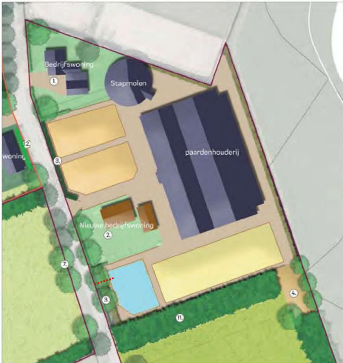
Afbeelding 35: Weergave beoogde ligging wadi locatie Bosrand 3 en ongenummerd. Globale ligging overstort op bestaande perceelssloot weergegeven met rode stippellijn. (Bron: landschappelijk inpassingsplan, Bijlage 5)
