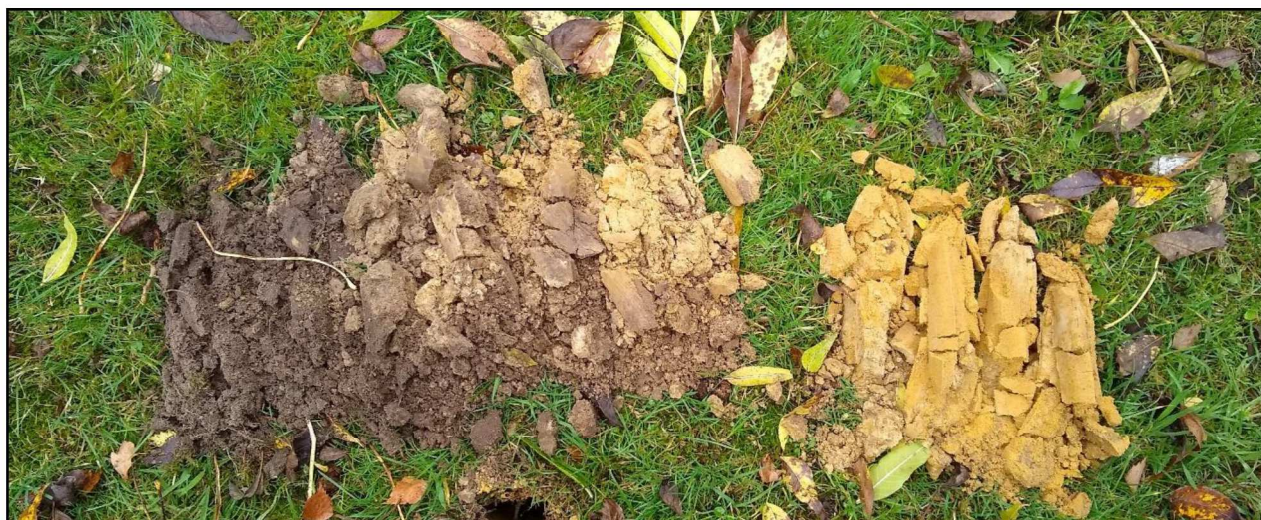
Figuur 7: boorprofiel van boring 6. De leesrichting is van rechts naar links.
