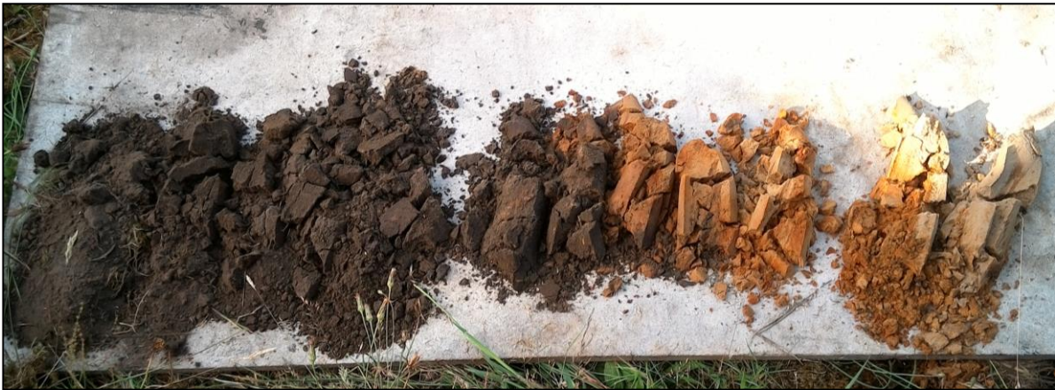
Figuur 7: Het boorprofiel van boring 1. De leesrichting is van links naar rechts (0-120 cm –mv).
