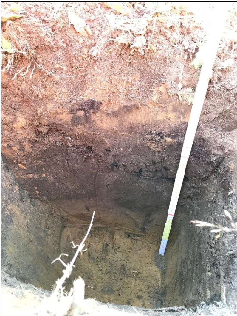
Figuur 8: Zicht op het profiel van het profielputje dat overeenkomstig de boringen bestaat uit een Aa-horizont die op de gele C-horizont ligt. (Het bovenste deel van het antropogeen dek lijkt licht van kleur maar dit vertekend door het zonlicht wat deels op de lens valt.)
