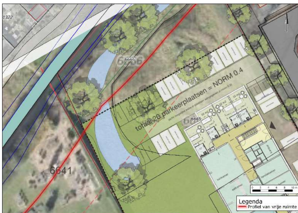
Figuur 7: Profiel van vrije ruimte
