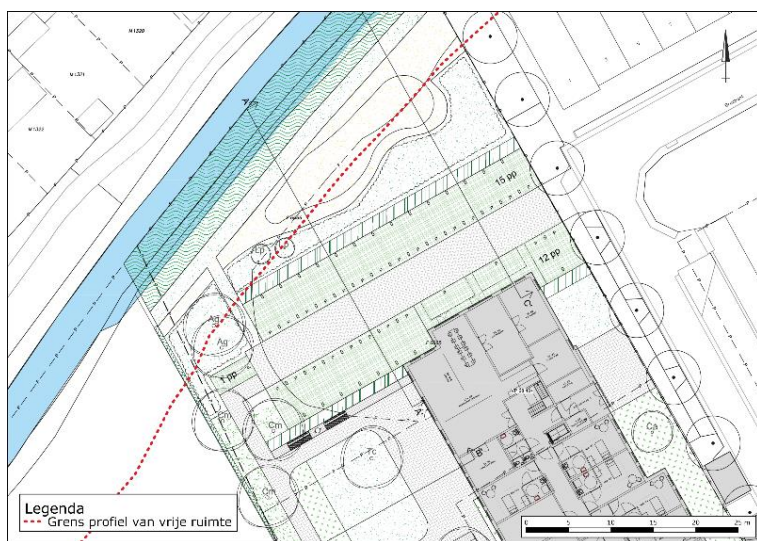
Figuur 6.1 Profiel van vrije ruimte
