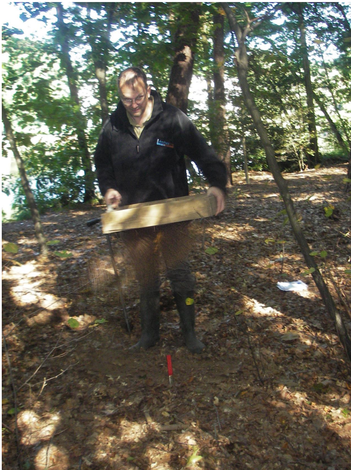
Figuur 22: Het zeven van het met de megaboer opgeboorde zand
