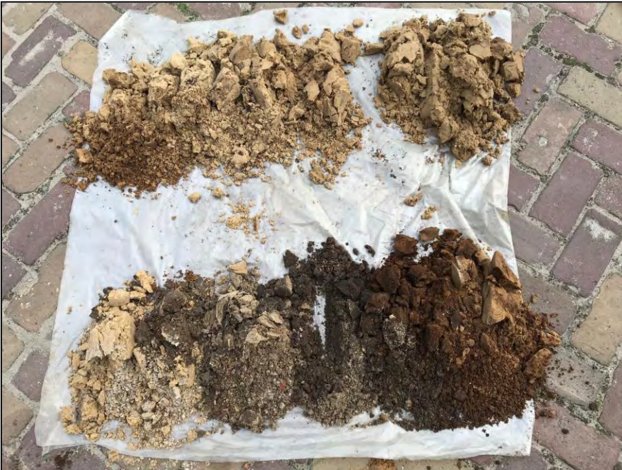
Figuur 7: Het profiel van boring 3, duidelijk is de bruine B-horizont te herkennen (leesrichting van linksonder naar rechtsboven).
