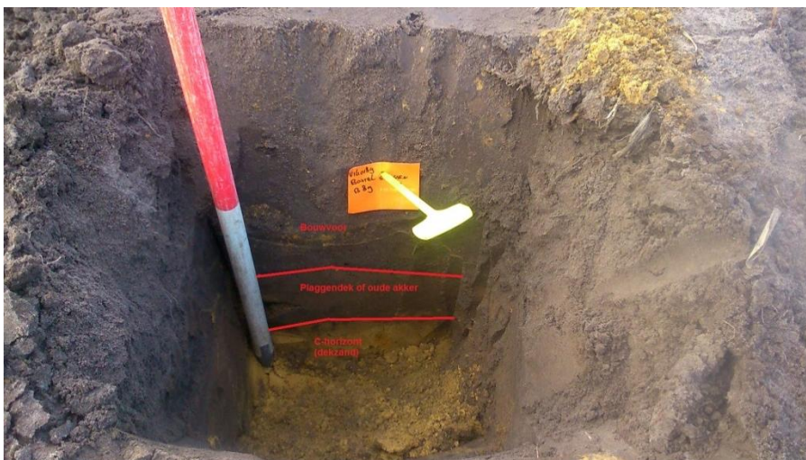
Figuur 3.3 Profielputje ter plaatse van boring 89. De bouwvoor is 30 cm dik en gaat geleidelijk over in een oudere fase van het plaggendek. Onder het plaggendek komt hier dekzand met roestvlekken voor.
