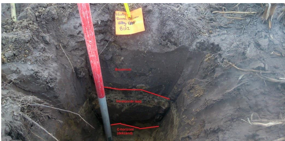
Figuur 3.4 Profielputje ter plaatse van boring 162. De bouwvoor is 30 cm dik en gaat met een scherpe laag over in een 20 cm dikke gevlekte laag, waar de bouwvoor met het onderliggende dekzand is gemengd. De textuur van het dekzand is matig fijn (150-210 \mu\text{m} ) en de zandkorrels zijn goed gesorteerd. Het zand heeft een laag siltgehalte (fractie 2-50 \mu\text{m} ) en is geelgrijs van kleur.
