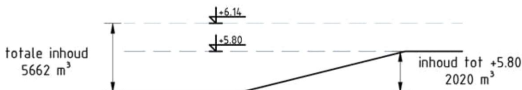
Figuur 1-2: schematische weergave inhoud retentie
