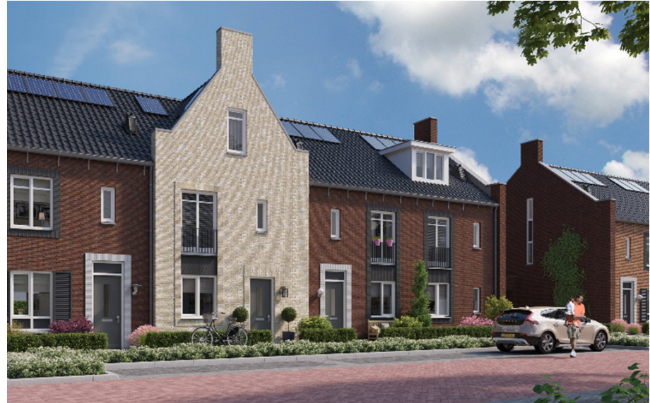
Doorgetrokken kopgevels met baksteendetails
