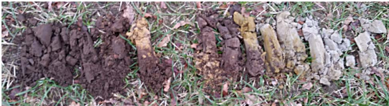
Figuur 5: De van links naar rechts uitgelegde boring 4. De lege ruimte in het midden markeert 50cm boordiepte. Duidelijk zichtbaar is de (donker gekleurde) begraven A-horizont, vanaf ca. 55cm -maaiveld.
