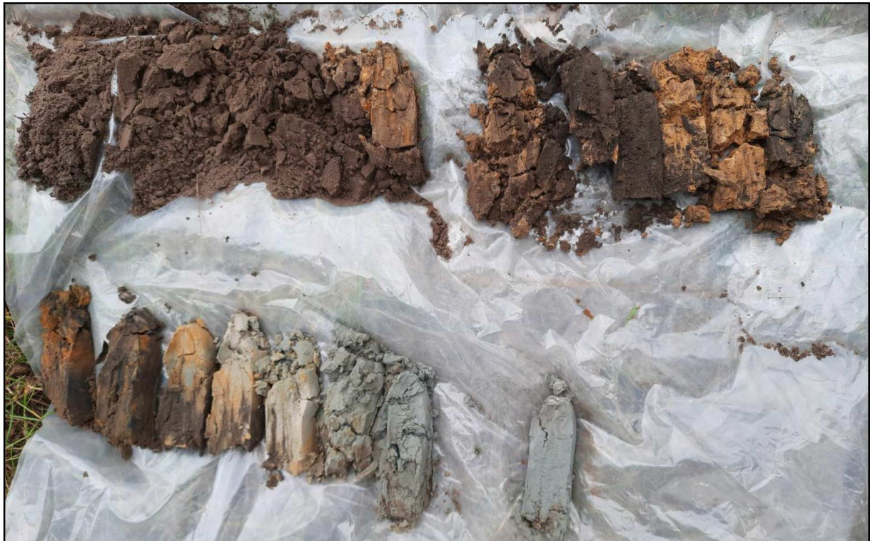
Figuur 8. Boorprofiel boring 6 (0 - 140 cm -mv). Leesrichting linksboven naar rechtsonder.
