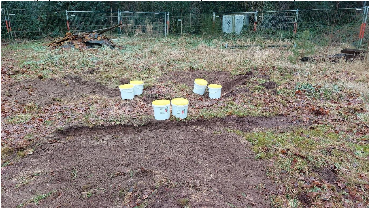
Afbeelding 3: proefsleuven ten behoeve van de visuele inspectie asbest rondom meetpunt 03
