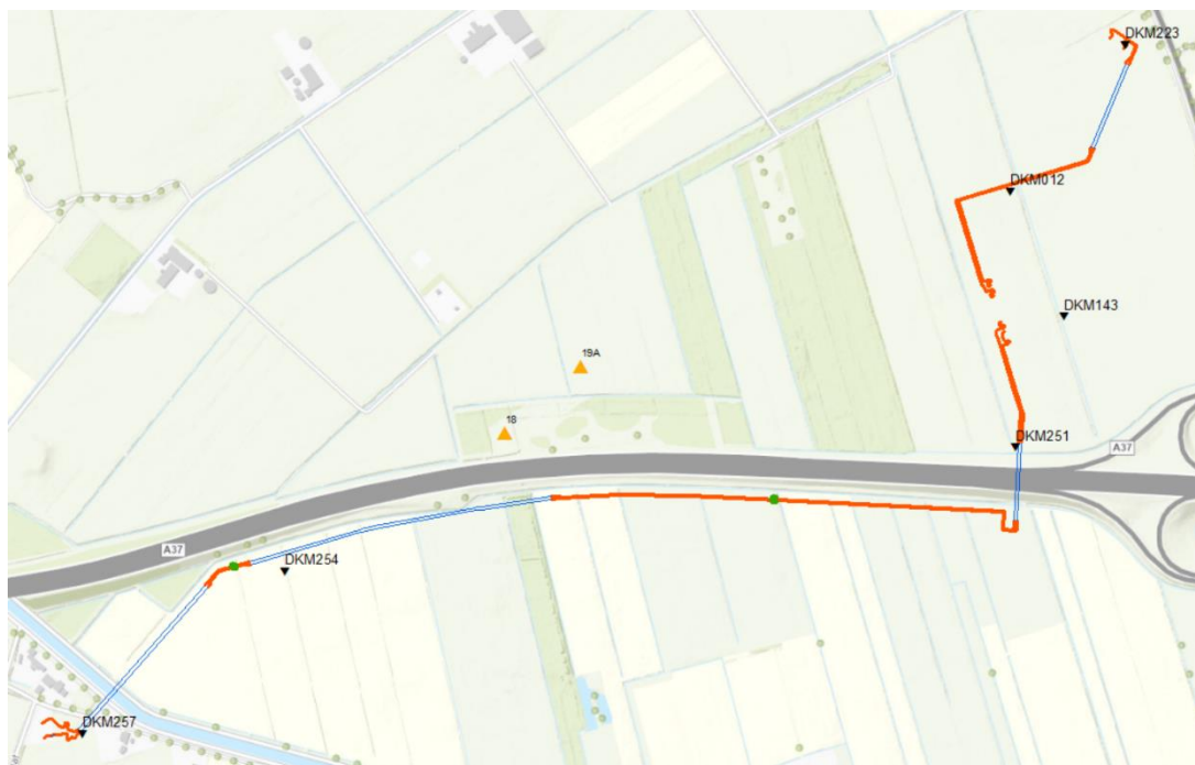
Figuur 3.3 Een overzicht van de geselecteerde sonderingen (rood is ontgravingstracé, geel is gestuurde boring met pers en ontvangstuip). In de buurt van de nieuwe masten (oranje driehoeken) zijn geen sonderingen gezet
