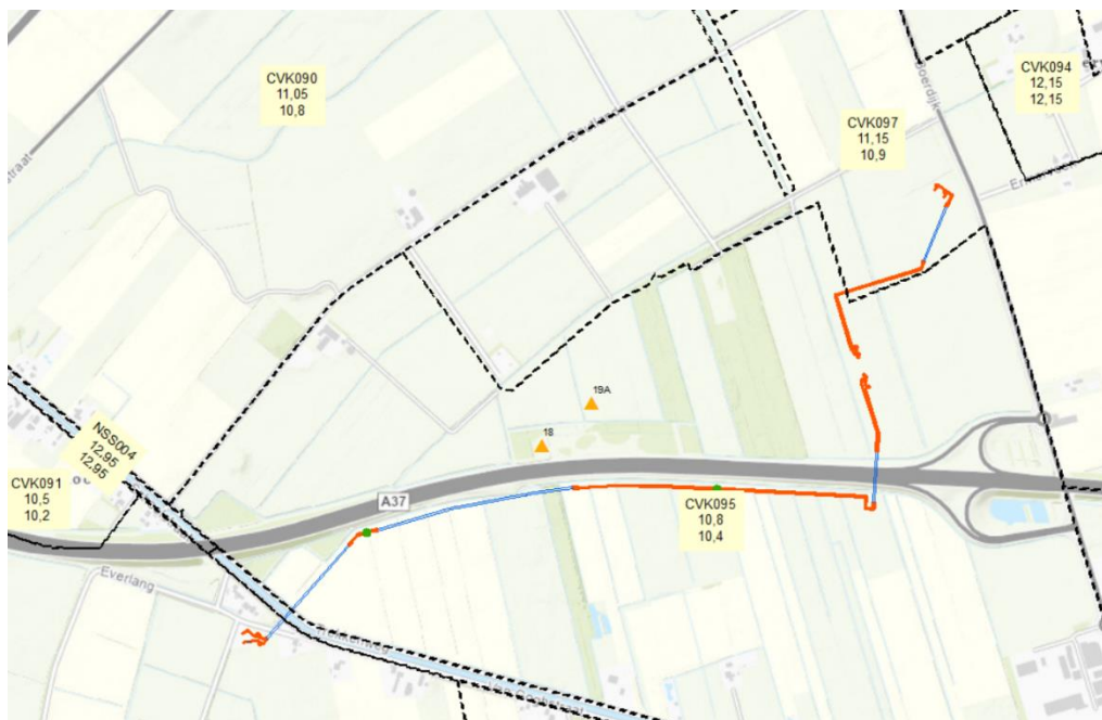
Figuur 3.4 De peilgebieden van waterschap Vechtstromen rondom de voorgenomen werkzaamheden. Respectievelijk zijn de code, het zomerpeil in m NAP en het winterpeil in m NAP aangegeven.
