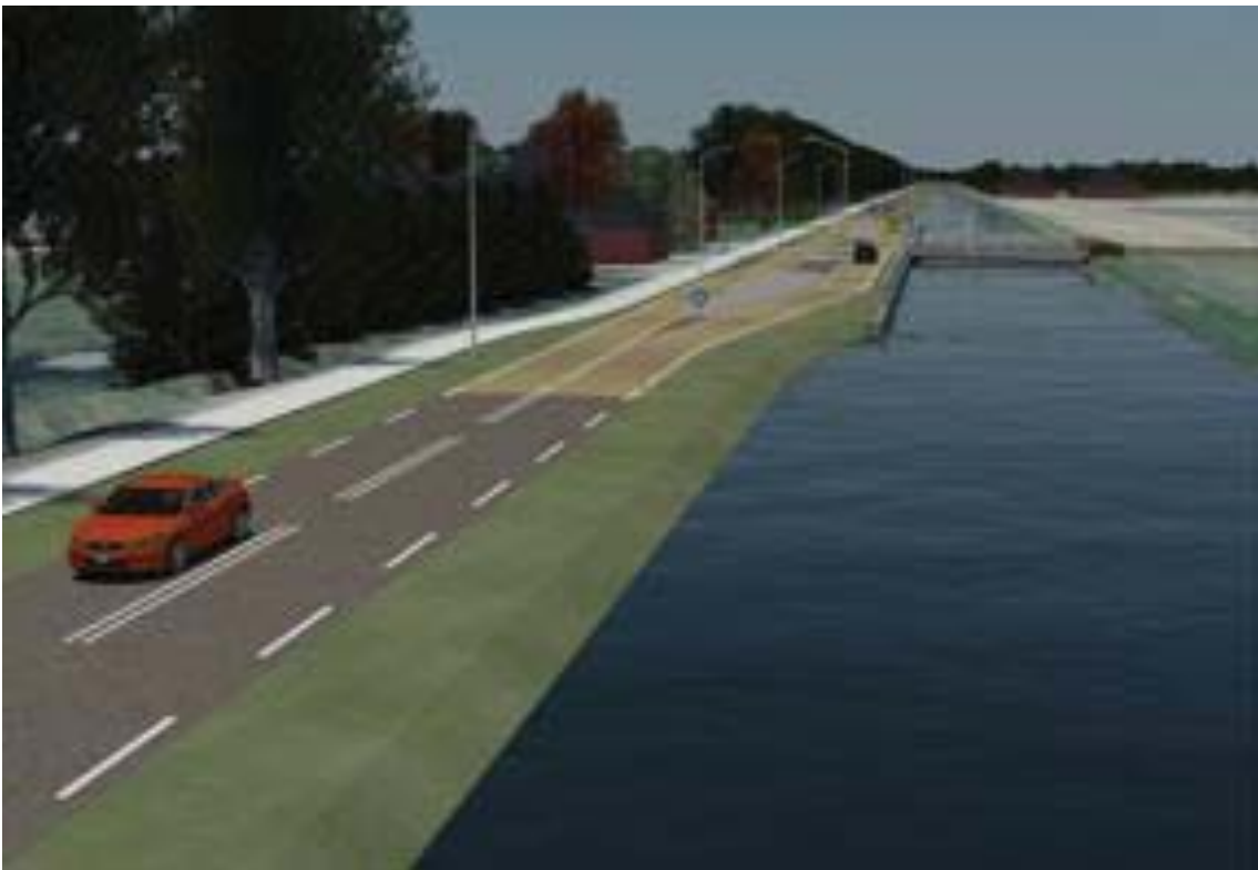
Afbeelding 3.3 Aansluiting Domeinweg: twee voor fiets- en gemotoriseerd verkeer gescheiden bruggen vervangen een dam
