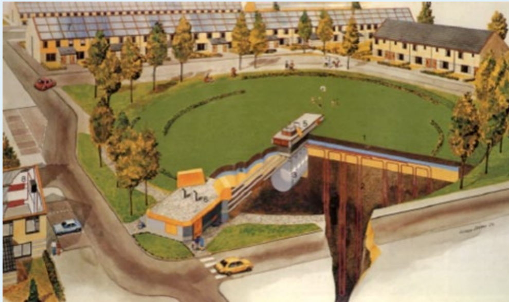
Figuur 2.1 Bij het project Beijum (Froukemaheerd) in Groningen wordt warmte opgeslagen die met behulp van zonnecollectoren wordt ingevangen.
