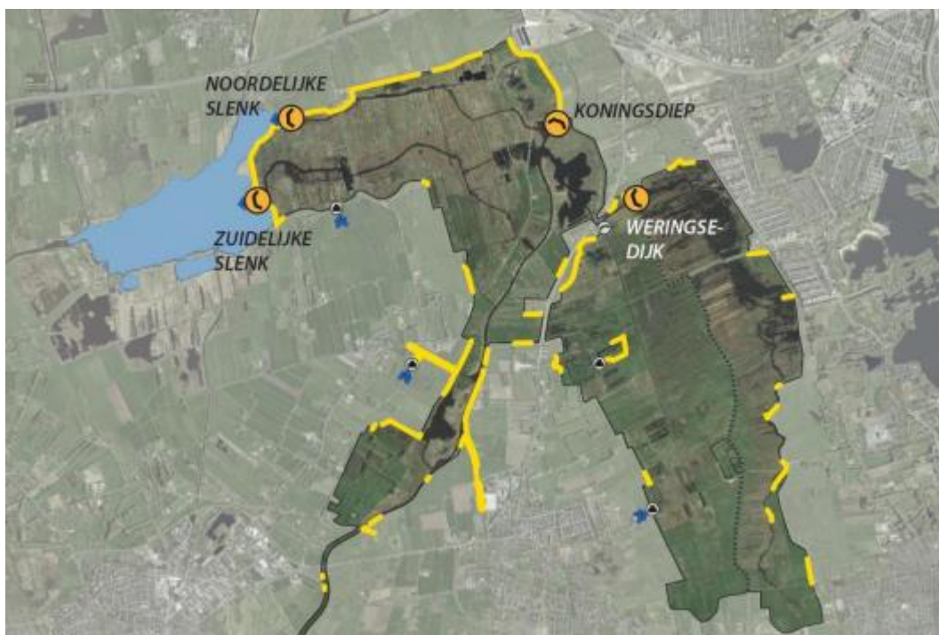
Figuur 5: Maatregelen voor variant 1: het aanpassen van drempels, stuwende (oranje symbolen) en kades (gele lijnen).
