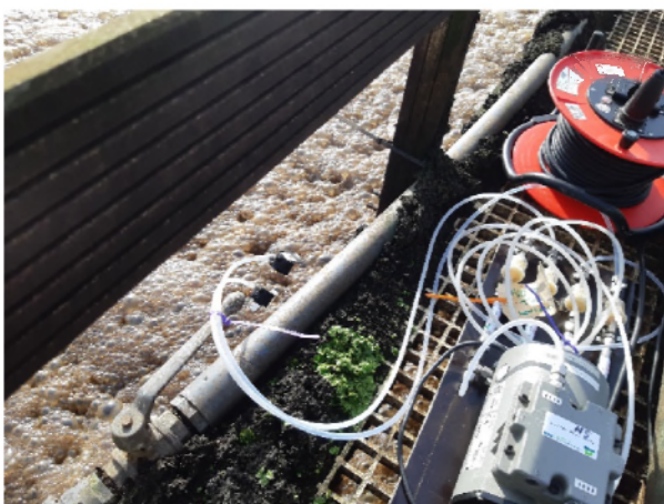
Foto's B3.3 Bedrijf 1 metingen endotoxines door middel van filters in IOM koppelingen boven de beluchtingstank tevens luchtpomp zichtbaar.
