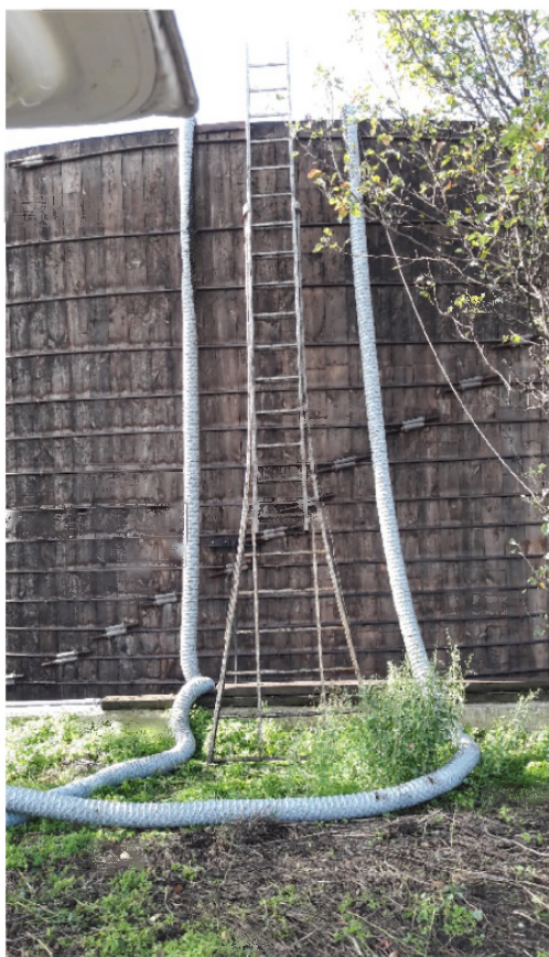
Foto B2.1 en B2.2 Aan en afvoerbuizen lucht en meetbox op schuimlaag aerobe silo Bedrijf 1.
