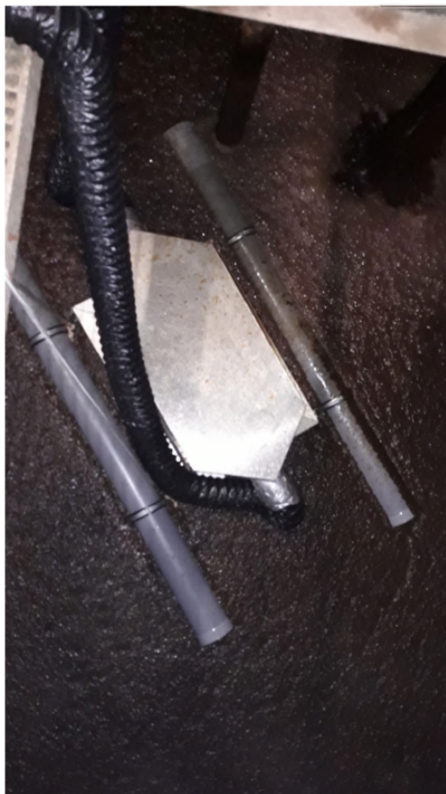
Foto B2.3 Drijvende meetbox op oppervlakte anaerobe silo Bedrijf 1 en B2.4 anaerobe silo Bedrijf 2.
