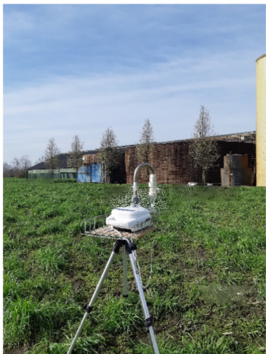
Foto's B3.1 en B3.2 Bedrijf 1 referentiemeting (B3.1) en metingen boven beluchtingstank (B3.2) met duidelijk de Coriolis apparaten zichtbaar met gevulde cuvetten voor monstername bacteriën.
