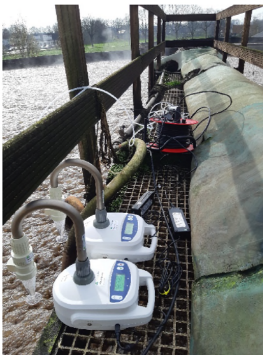
Foto's B3.1 en B3.2 Bedrijf 1 referentiemeting (B3.1) en metingen boven beluchtingstank (B3.2) met duidelijk de Coriolis apparaten zichtbaar met gevulde cuvetten voor monstername bacteriën.
