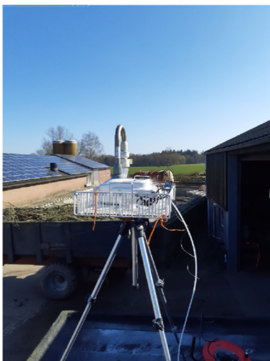
Foto B3. Referentiemeting buiten zichtbaar (uitgevoerd op het dak van een nabijgelegen bouwkeet).
