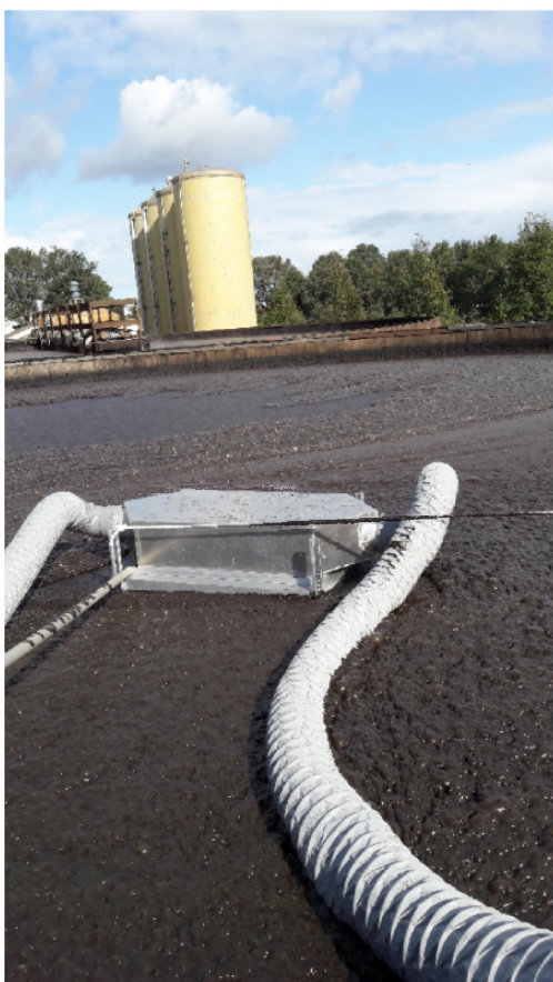
Foto B2.3 Drijvende meetbox op oppervlakte anaerobe silo Bedrijf 1 en B2.4 anaerobe silo Bedrijf 2.
