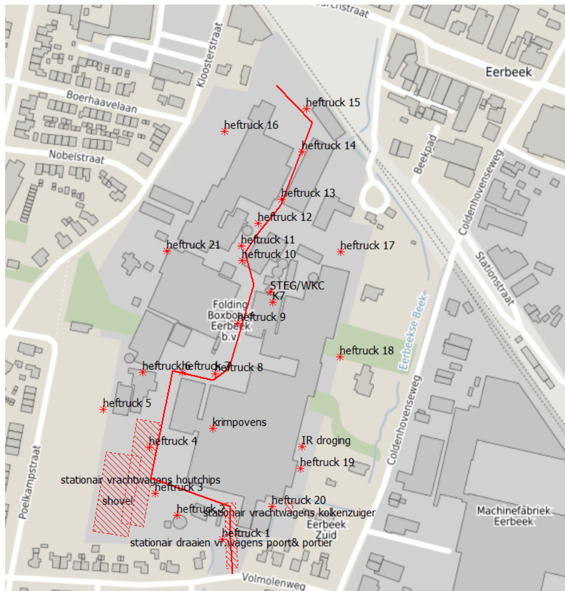
Figuur 5.1 Emissiebronnen in de referentiesituatie op het terrein van Folding Boxboard Eerbeek. Sterretjes betreffen puntbronnen en heftrucks, gearceerde vlakken de oppervlaktebronnen (inzet shovel en stationair draaiend vrachtverkeer) en de lijn de vrachtwagenbewegingen op het terrein van Folding Boxboard Eerbeek.
