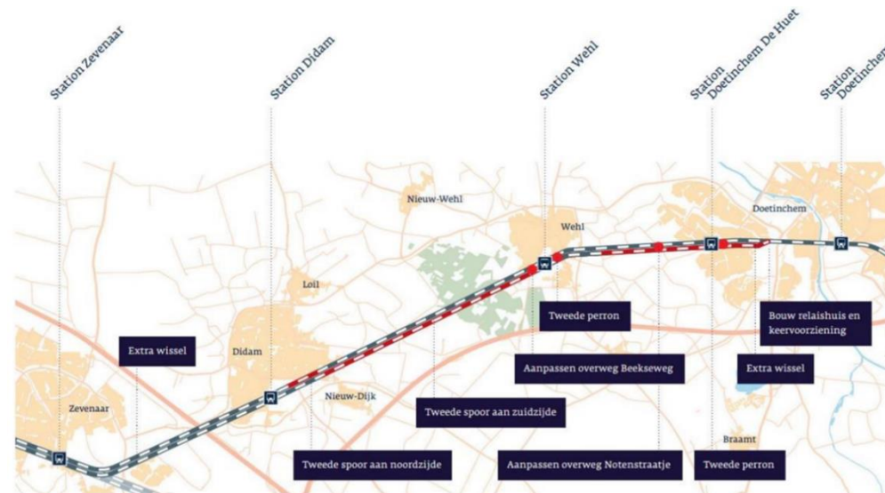
Figuur 11: De spoorverdubbeling en aanvullende spoorse-maatregelen
