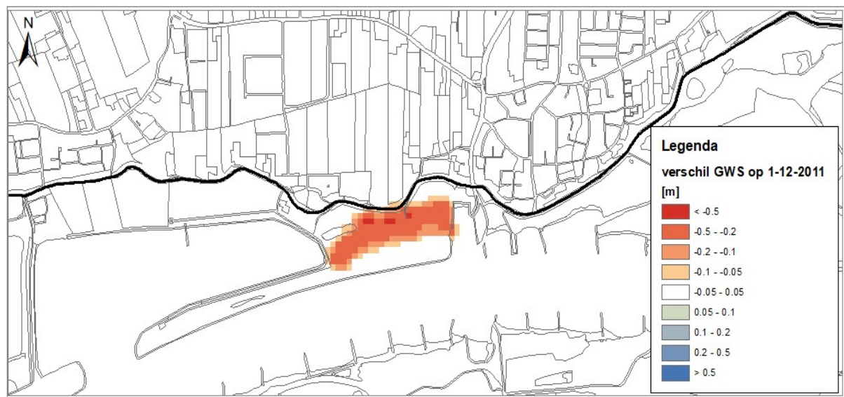
Figuur 6-27: Berekende effecten op de grondwaterstand voor variant 2 bij laagwater T10 (herhalingsjijd 10 jaar).
