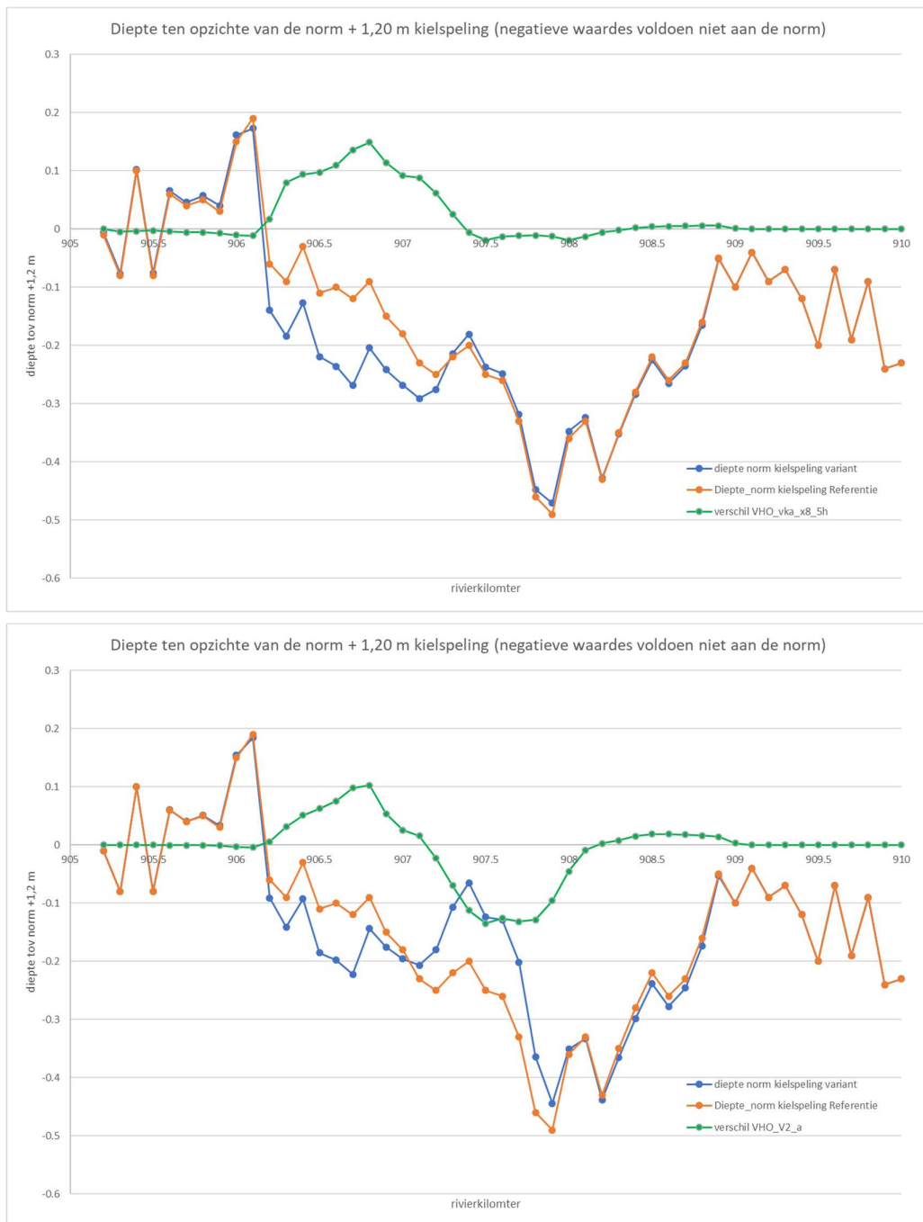
Figuur 6-9 Breedtegemiddelde diepte van de vaargeul ten opzichte van de norm (2,8 m waterdiepte t.o.v. OLR) plus kielspeling (+1,20m) voor variant 1 (boven) en 2 (onder), o.b.v. de resultaten van de jaargemiddelde WAQ morf berekening. Negatieve waarden voldoen niet aan de norm.
